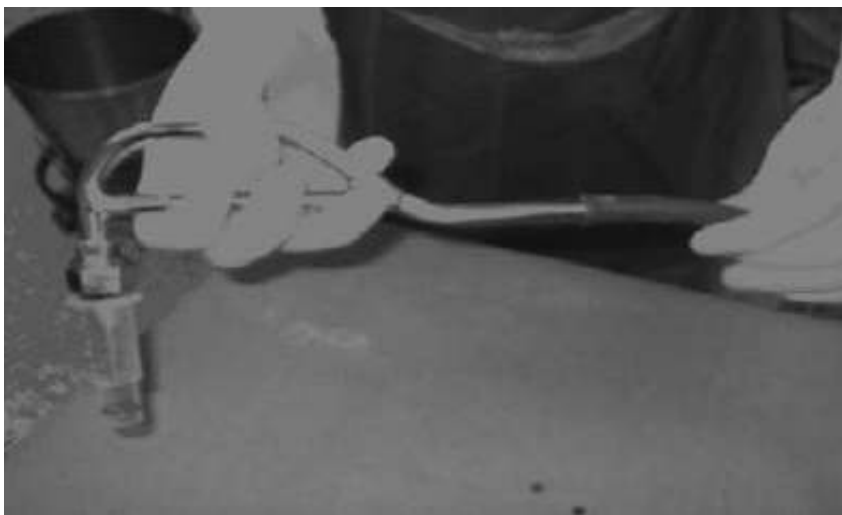
Gambar 6.9 Menyambungkan Handling Part ke Unit Penyedot
