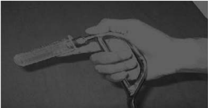
Gambar 6.11 Pendorongan Tabung Luar untuk Melepaskan Karet Pengikat
